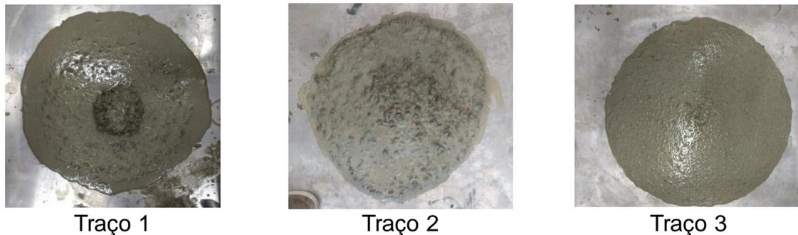
De acordo com a NBR 15823, existem quatro índices de estabilidade visual (IEV), conforme mestrado na Figura 4.
